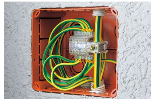
Ejemplo de uso de las regletas de bornas tipo Z35T-11 sin interrupción del montante como nodo equipotencial de tierra
